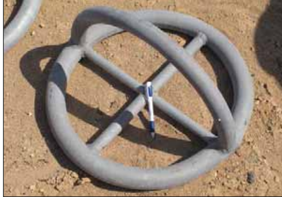
اللوحة 19 خاتم فولاذي مستخدم كصفيحة زاويّة. يسمح هذا المكوّن بربط الحبل مباشرة على الخاتم الفولاذي دون استخدام الأصفاد
