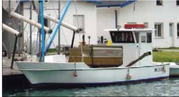
اللوحة 109 قارب مجهز بمدفع غذاء نصف آلي. في هذه الحال المدفع مجهز بقادوس ضخّم لتخزين كثير من الغذاء. تُضَبَط الكمية الواجب نثرها من الغذاء على كل قفص من قبل ربان القارب الذي يستخدم أداة تحكم الكترونية على البرج
