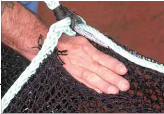
اللوحة 76 تكون مخاطر قصور الشبك أكبر عند الحبال المُستعرضة نظراً للقوى الفاعلة كما هو موضح في اللوحة 73. أحياناً لا يكون نسيج الشبك مَخِيطاً مع الحبال عند نقاط الارتباط، ذلك لتوزيع القوى على عديد من النقاط والإقلال من احتمال قصور الشبك إلى الحدود الدنيا
