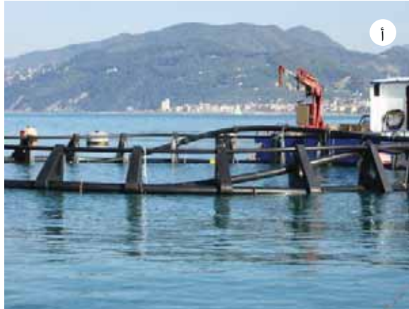
اللوحة 39 أنبوب الإغراق. (أ) أنبوب إغراق مثبت مؤقتاً على سياج القفص، لتسهيل عملية النقل من المرفأ إلى الموقع، (ب) أنبوب إغراق مُركَّب
