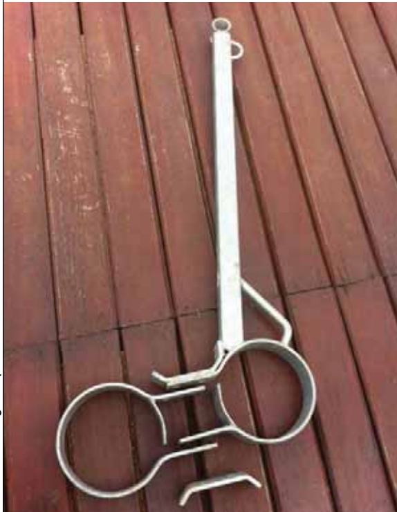
اللوحة 28 مكوّنات مَفَكَّة لهلال فولاذي مغلفن
