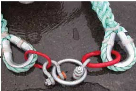
اللوحة 18 خواتم فولاذية مستخدمة لوصل حبلين ذوي جديلة عينية بحلقاتٍ من خلال زوج من الأصفاذ. صفاذ آخر يربط الخاتم الدائري بالصفيحة الرأويّة
